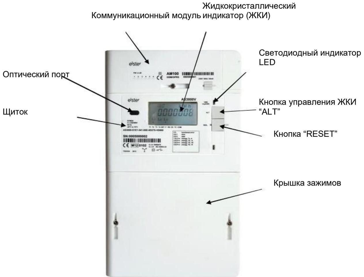
Коммуникационный модуль располагается в верхней части счетчика и крепится к основанию одним винтом. Питание коммуникационного модуля осуществляется от внутренней шины счетчика через разъем, расположенный на плате электронного модуля.
