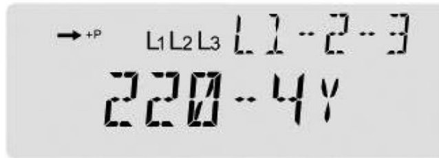
Рисунок 8.2 -Чотирихпровідна мережа з номіальною напругою 220 В
