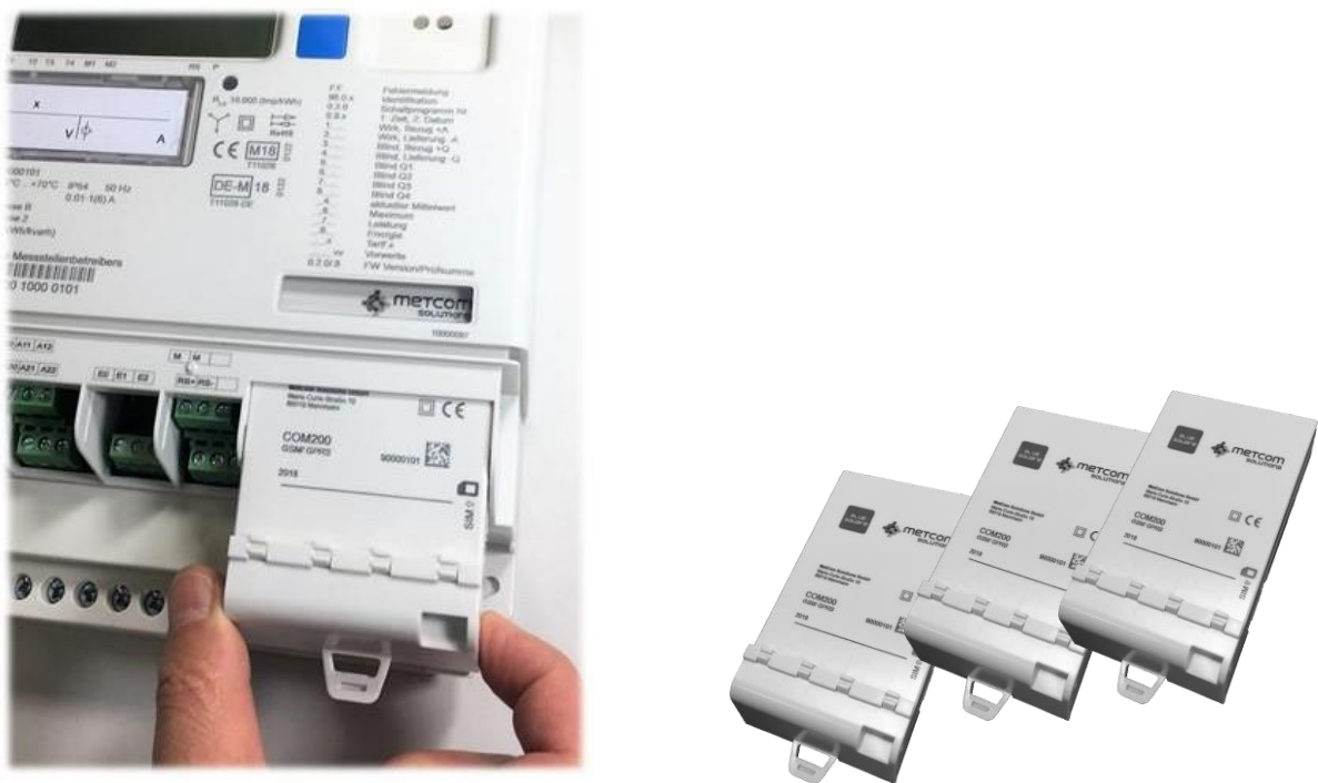
Рисунок 16: Лічильник MCS301 з комунікаційним модулем
