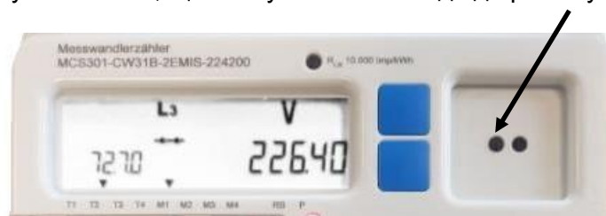
Рисунок 12: Оптичний інтерфейс з оптичним сенсором
