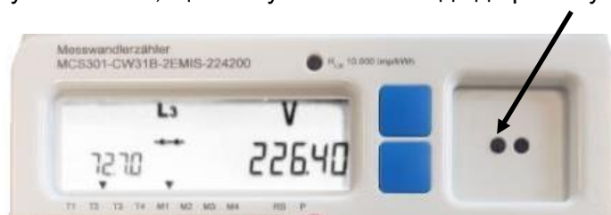
Рисунок 4: Оптичний інтерфейс з оптичним сенсором
